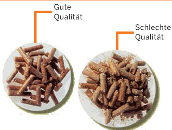
Vergleich von Pellets mit guter und schlechter Qualität Bild: Umdasch, Amstetten Österreich
